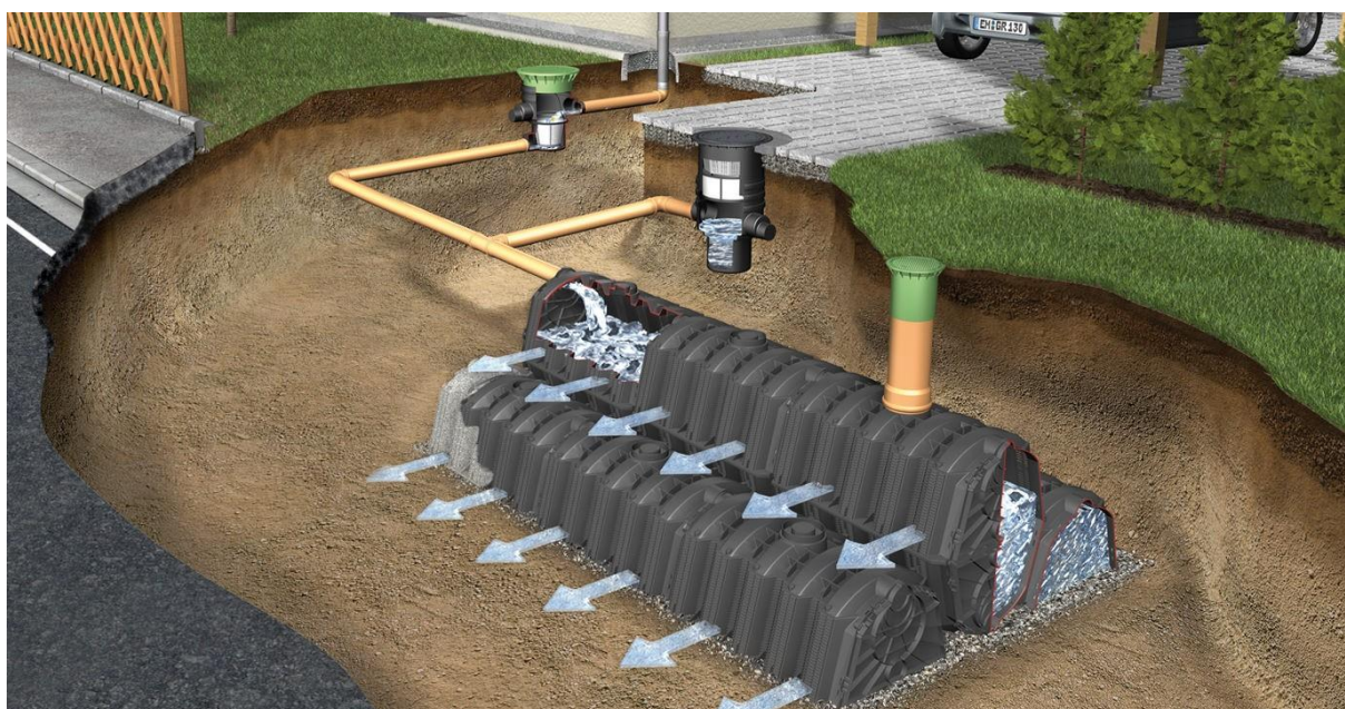
Foto 5 – Zasakovací tunel, ilustrační obr., zdroj Garantia
